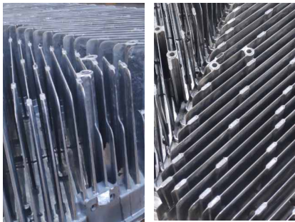
■ 5G基站散热器壳体，散热齿高度达130mm
