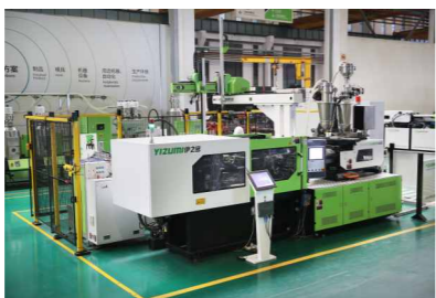
P17 产品 在线配混免造粒、免干燥 直接注塑成型方案
