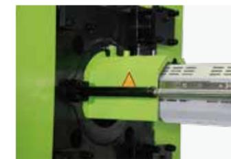
标配射嘴防护罩、料筒护罩
