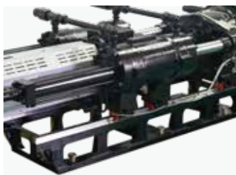
Suporte da unidade de injeção com trilhos de guia lineares
