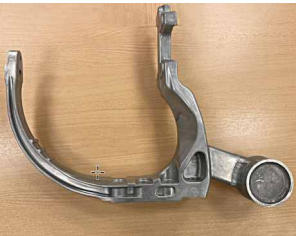
产品重量：9 kg 用T6代替重力铸造减少机械加工
