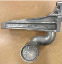
产品重量：14 kg 用T6代替重力铸造减少机械加工
