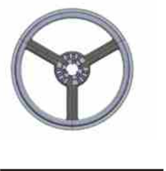
制品名称：轮子 生产机型：UN500D1 成型腔数：一出二 材料：PP、PP+50%GF 重量：668g
