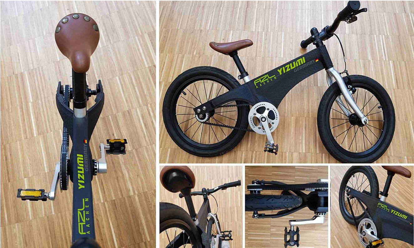
图二：伊之密3D打印自行车车架，减轻了结构件42%的重量。
