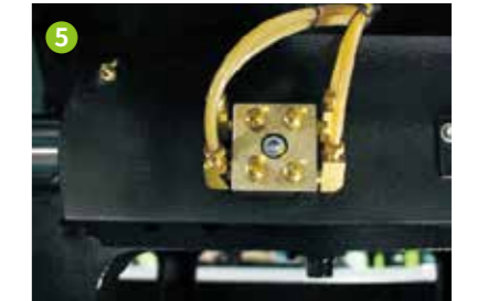
集中潤滑模塊 Centralized lubrication module
