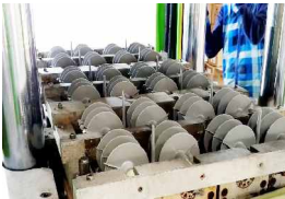
制品名称：11kV复合绝缘子 成型腔数：一出二十四 Part Name: 11 kV Composite Insulator Number of Cavities: 24
