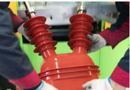
制品名称：10kV互感器 成型腔数：一出二 Part Name: 10 kV Transformer Number of Cavities: 1
