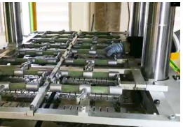
制品名称：11kV熔断器 成型腔数：一出十六 Part Name: 11kV Cut-out Number of Cavities: 16
