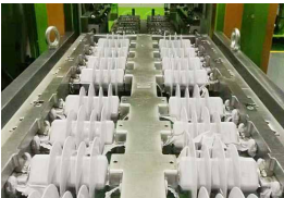
制品名称：11kV避雷器 成型腔数：一出十六 Part Name: 11 kV Arrester Number of Cavities: 16
