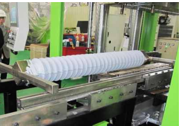
制品名称：110kV避雷器 成型腔数：一出二 Part Name: 110kV Arrester Number of Cavities: 1
