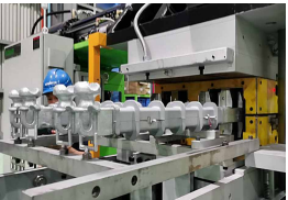
制品名称：20kV复合横担 成型腔数：一出四 Part Name: 20kV Composite Crossarm Number of Cavities: 4
