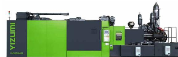
伊之密从2009年开始研发半固态镁合金注射成型装备及其工艺。为实现稳定的产品生产，伊之密半固态镁合金注射成型机连接中欧技术，引进热流道技术，可以增加注射量、改善填充性能和产品整体质量。
