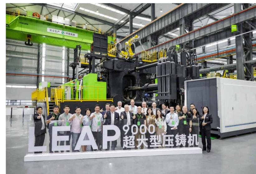
此次与一汽铸造公司战略签约的LEAP9000T压铸机，正是为了一汽新能源汽车的后地板超大型压铸件而量身打造的。据介绍，一汽新能源汽车的后地板超大型压铸件的外围尺寸约1875x1617x736mm，是目前市场上已知超大型压铸件中最大的，同时也预示着国产汽车品牌在新能源汽车超大型压铸件上开始发力。
