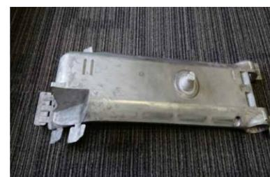
■ 单点式热流道（电动踏板车底板）
