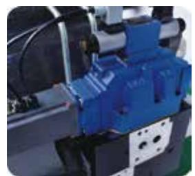
**Высокоскоростной пропорциональный клапан открытия/закрытия пресс-формы**
