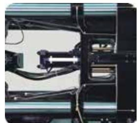
**Параллельная работа толкателя и открытие формы**
