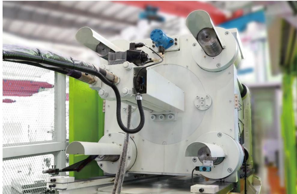
Ein hydraulisch angetriebener Motor der Marke Vickers mit stabiler, schneller und langlebiger Steuerung wird verwendet.
