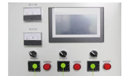
Düsentemperatur    Gooseneck-Temperatur    Ofentemperatur
